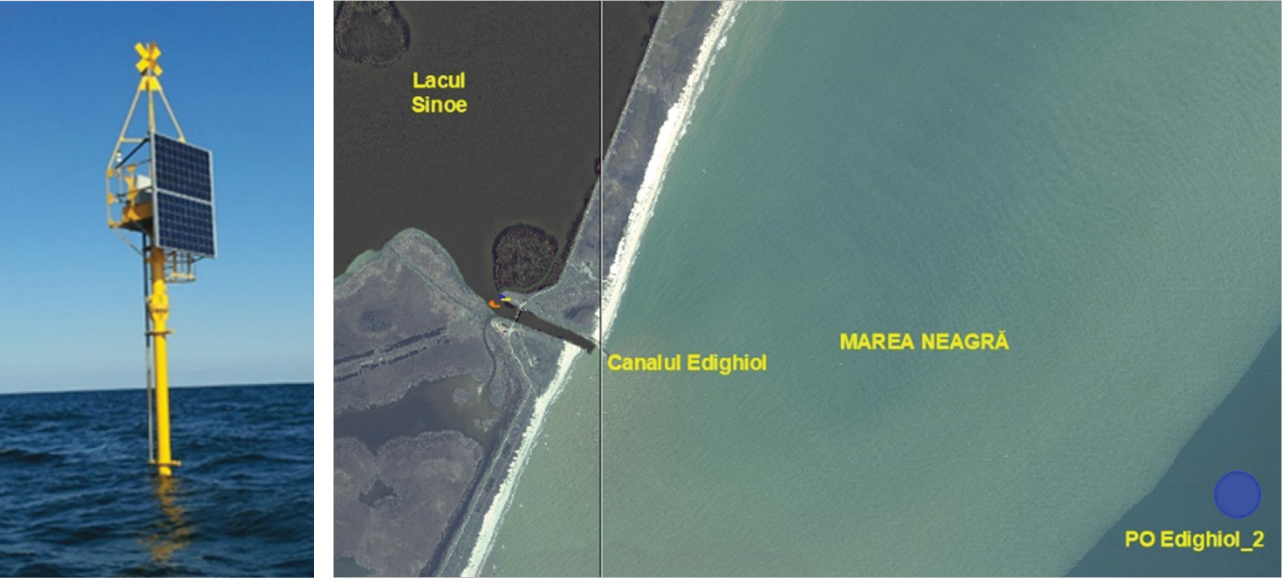
2. Edighiol_2: Baliză Costieră: baliza se va monta la izobata de (-15,00) m în dreptul Canalului de legătură între Lacul Sinoe - sistemul hidrotehnic (ecluză) și Marea Neagră. Accesul la Edighiol_2 se va face exclusiv de pe apă, cu ajutorul navei maritime tehnice dedicate special întreținerii tuturor geamandurilor și balizelor costiere ce vor aparține DANUBIUS-RO.
